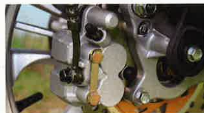
Bremszange hinten mit felsenfester Schraubensicherung
