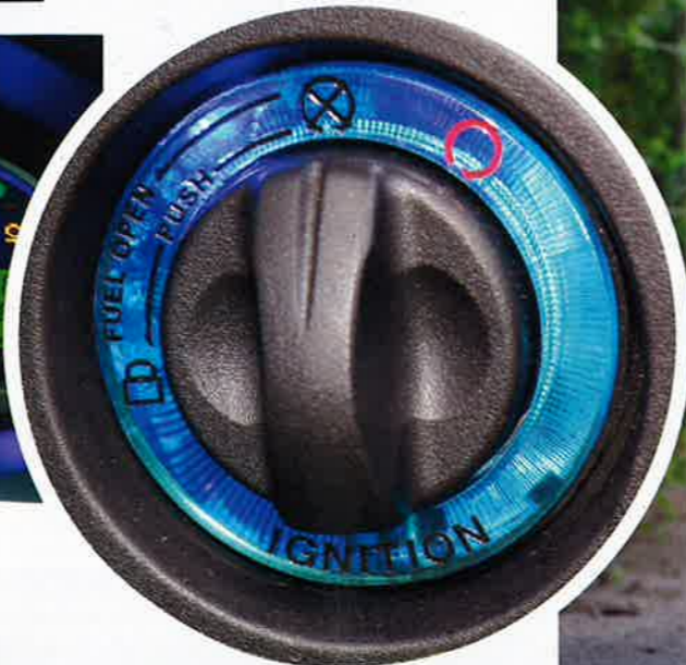
Der von betörend blauem Licht irisierte Zündschalter wird vom Funkschlüssel drahtlos freigeschaltet
