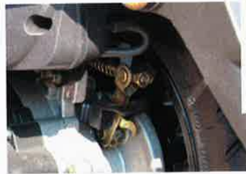
Übliche Trommel hinten und ein sehenswertes Sicherungsblech an der Schrauben der vorderen Bremszange
