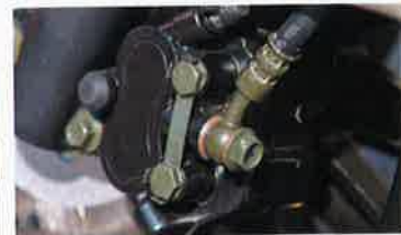
Übliche Trommel hinten und ein sehenswertes Sicherungsblech an der Schrauben der vorderen Bremszange
