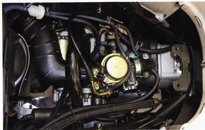
Ein typischer Zweiventilviertakter mit Vergaser und Sekundärluftsystem
